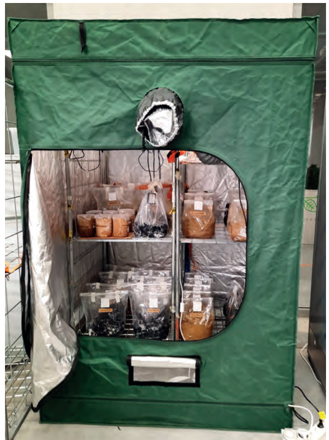
Kasvatusteltta, jossa online-mittaus hiilidioksidille, kosteudelle ja lämpötilalle.
