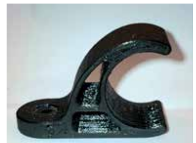
Metsäkoneyritys Ponsse on tulostanut muovitulostimellaan tuotannon apuvälineiksi yksinkertaisia työkaluja. Kuvissa keltainen on saattomutterikehä ja musta karanasennustyökalu.
