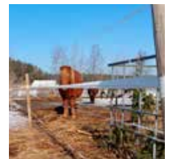
Nauhaa on testattu mm. aitausnauhana. Nauha venyi märällä ilmalla ja pingottui taas kireäksi kuivessaan.
