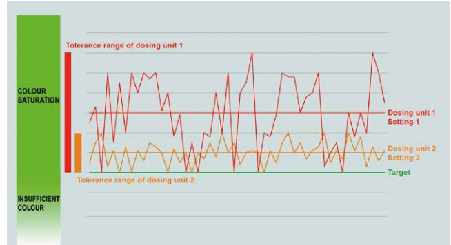
Suuremman annostelutarkkuutensa ja paremman toleranssialueensa ansiosta annostelulaite 2 mahdollistaa asetusarvon pienentämisen ja säästää siten lisäaineita.
