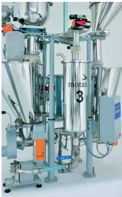
Jatkuva gravimetrisen annosteluasema (loss-in-weight), jossa on kaksi ruviannostelumuodulia jauheelle ja rakeille sekä nesteannostelupumppu. Keräysastia näkyy kuvan alaosan keskellä.
