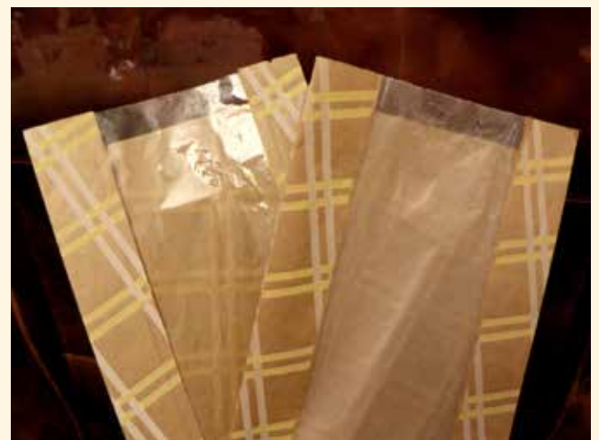
Kuva 6. Viimeisin muutos, pussin muovi-ikkunan materiaali vaihdettu, uusi oikealla.
