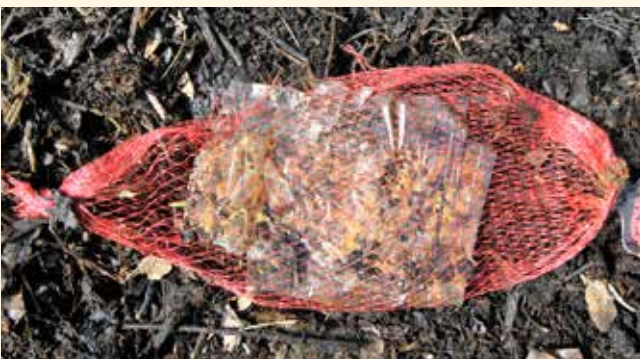
Kuva 5. Kompostoituminen muoviverkossa, rullattu pussi laitettiin säiliöön 13.9.2021 ja otettiin pois 1.6.2022.
