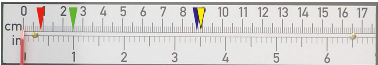
Kuva 557. Kuvan asteikko on kuvattu uudesta Engel ruiskuvalukoneesta. Kuvassa punainen neula on vasemmalla ruuvin alkuasennossa aivan edessä. Maksimi annosmatka on 170 mm. Sininen kolmio osoittaa asetettua annosmatkaa ja keltainen kolmio ruuvin asentoa niiston jälkeen, mikä on lopullinen asema ennen ruiskutusta. Ruiskutuksen aikana ruuvi liikkuu nopeasti asemaan jossa jälkipaineelle vaihto tapahtuu vihreällä kolmiolla merkityssä asemassa. Sen jälkeen ruuvi liikkuu hitaasti eteenpäin lopulliseen asemaansa ennenkuin aloitetaan annostelu. Punaisella kolmiolla merkittyä lopullista asemaa kutsutaan tyynyksi.
