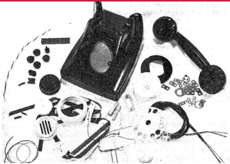
Kuvasta näkyy, miten suuri on tavalliseen puhelinkoneeseen sisältyvien erilaisten muoviosien lukumäärä.
