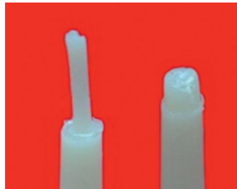
Kuva 526. Kuvassa kaksi erilaista valukanavaa. Vasemmanpuoleinen on ruiskuvalettu suuttimella jonka reiän halkisija on n. 4 mm pienempi kuin valutapin pienin halkisija. Oikeanpuoleinen on ruiskuvalettu suuttimella jonka reiän halkisija on n. 1 mm pienempi kuin valutapin pienin halkisija. Kappaleissa jotka valmistettiin (kiskotuki) vasemmanpuoleisella valukanavalla olivat n. 20% heikompia kuin kappaleet oikeanpuoleisella valukanavalla.
