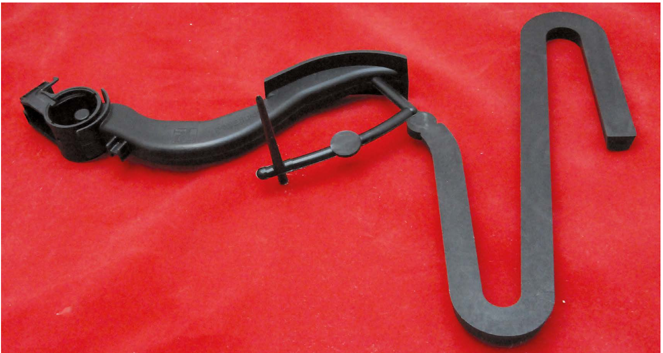
Kuva 363. Kuvassa ontto kytkinpoljin, joka on valmistettu lasikuitutäytetystä polyamidista kaasuvavusteisella ruiskutuksella. Kuvassa oikealla ylitäytätasku johon kaasu on työntänyt raaka-aineen kappaleen sisältä.
