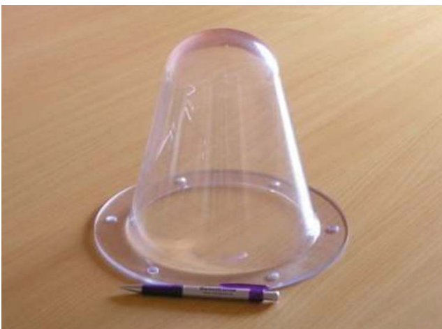
Kuva 359. Kuvassa tuote jota valmistaa Sematron AB tyhjömuovaamalla. Koska tuotteen muovaama muotti voidaan valmistaa puusta, saadaan kustannukset pysymään alhaisina ja jo 10 kappaleen sarjakoko voi olla taloudellisesti kannattava. Kun sarjakoko nousee yli 1000 kappaleeseen voi ruiskuvalu olla vaihtoehtoinen valmistusmenetelmä.
