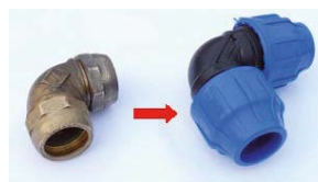
Kuva 368. Kulmaliitokset 32 mm:n PE-putkelle ovat esimerkki siitä, miten tuotteen mittoja ja toteutusta täytyy muuttaa muovista valmistetussa kappaleessa, jotta selvittää veden paineen ja liitosta kiinnitettäessä aiheutuvasta rasituksesta.
