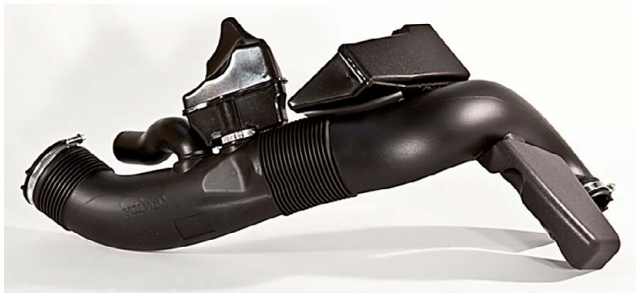
Kuva 364. Kuvassa kestopuovi-elastomeerista muottipuhallettu imuilmaputki Volvon 6-sylinteriseen bensiinimoottoriin. Se on hyvä esimerkki siitä, että myös monimutkainen muotoilu on mahdollista tällä valmistusmenetelmällä. Lähde: Hordagruppen
