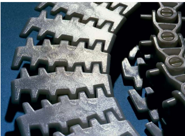
Kuvassa asetaalista valmistettuja ketjulenkkejä. Lisäämällä fluorimuovia tai silikonua voidaan sekä kitka- että kulumisominaisuuksia parantaa merkittävästi. Kuva: Flexlink
