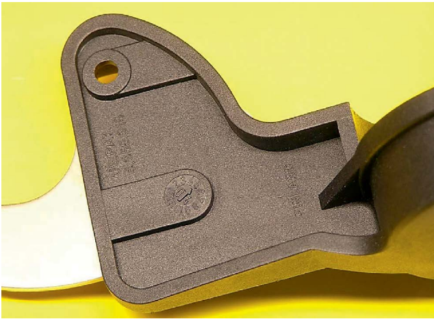
Polyamidista valmistettu kappale, jossa on matta kipinäpinta. Kipinöimällä muotti voidaan pinnanlaatua hallita paremmin kuin hiekkapuhaltamalla.
