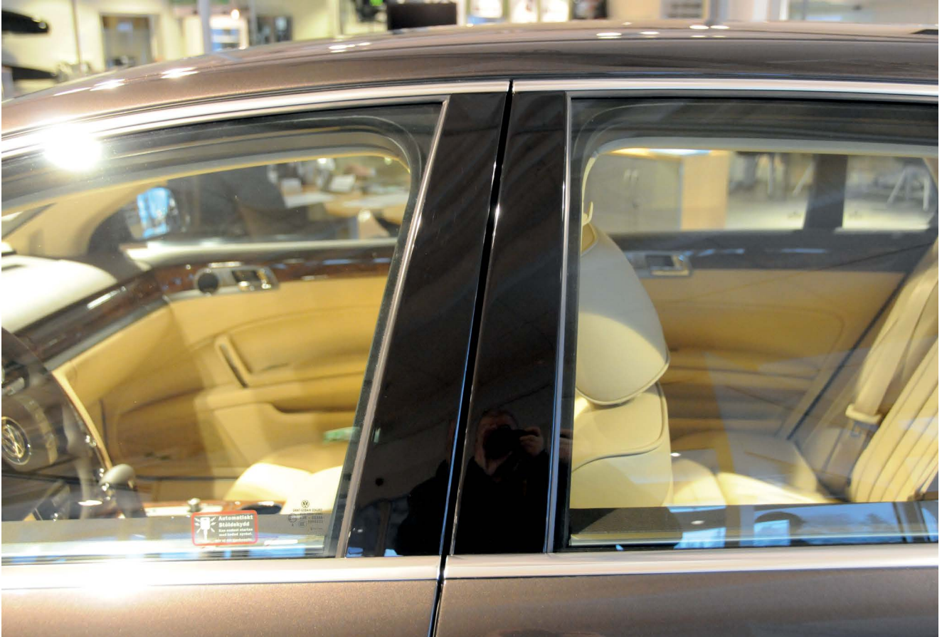
Henkilöauton ovipaneeja valmistettuna mustaksi läpivärijäystä PMMA raaka-aineesta. Pinta on kerkeakiiltoinen n.k. A-pinta.
