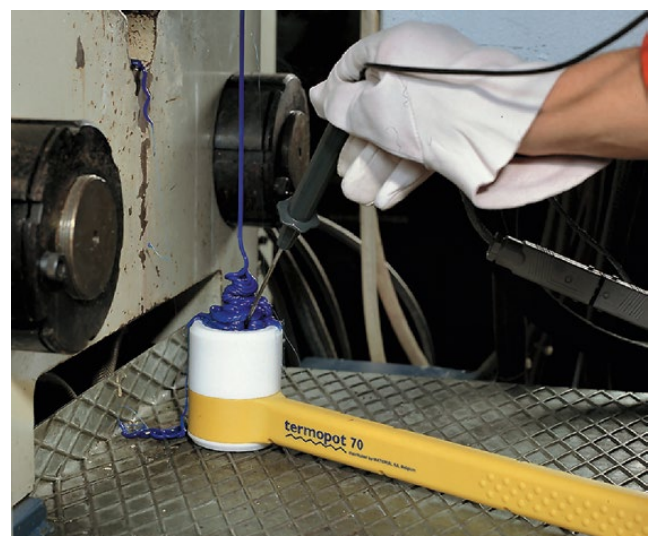
Kuva 536. Sulan lämpötilan mittaus Kuva: DuPont
