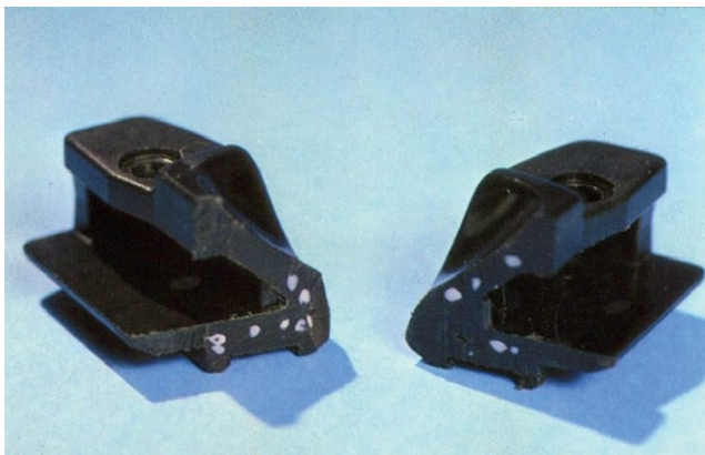
Kuva 533. Sulamatonta granulaattia asetaalikappaleessa Kuva:DuPont
