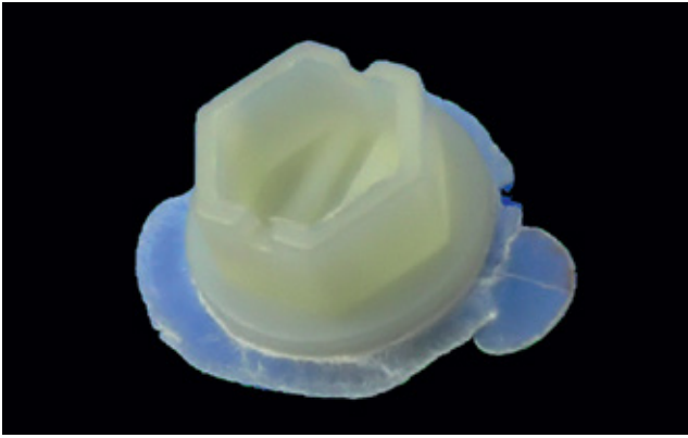
Kuva 544. Kuvassa polyamidista valmistettu kappale suurella jäysteellä jakotasossa. Jälkipainetta tulee lisätä pienissä portaissa ja lopettaa jo kun melkein näkymättömiä jäysteitä voi tuntea sormenpäällä.
