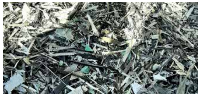
Komposiittijäte kiertää sementin raaka-aineeksi ja energiaksi Finnsementti Oy:n Lappeenrannan laitoksella.
