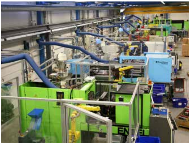
Realplastilla on panostettu pitkään automaatioon. Kaikissa ruiskuvalusoluissa on robotit.
