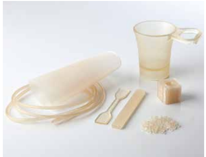
Kuva 1. VTT:n ThermoCell materiaalista ekstruusioilla, ruiskuvalulla ja 3D-printtauksella valmistettuja kappaleita.
