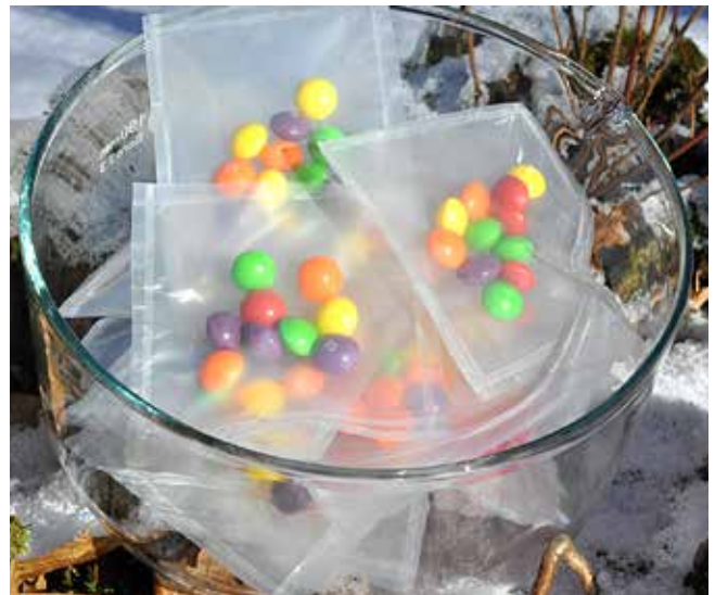
Kuva 4. VTT:n ThermoCell-materiaalista ja nanosellulasta valmistettuja 3-kerroskalvo pakkausdemoja.
