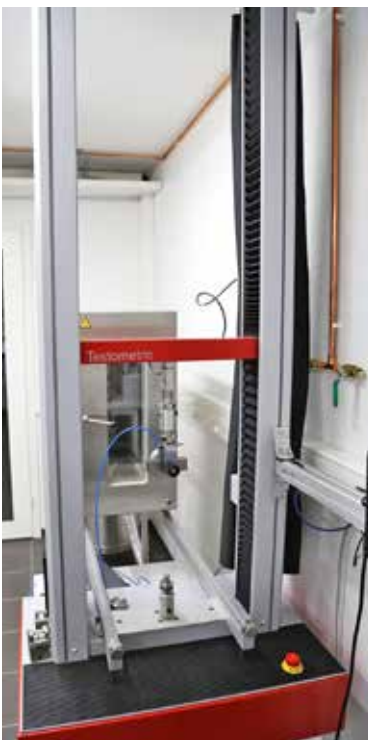
Olosuhdekaapissa voidaan tehdä myös vetotestejä äärimmäisissä lämpötiloissa (-70 °C - 300 °C)
