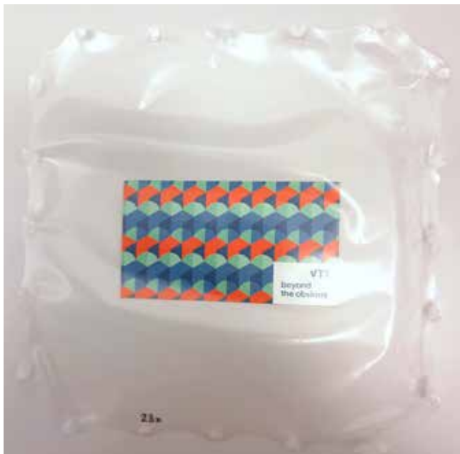
Kuva 3. 2,3 x 2,3 biaksiaalisesti orientoitu ThermoCell-kalvo.
