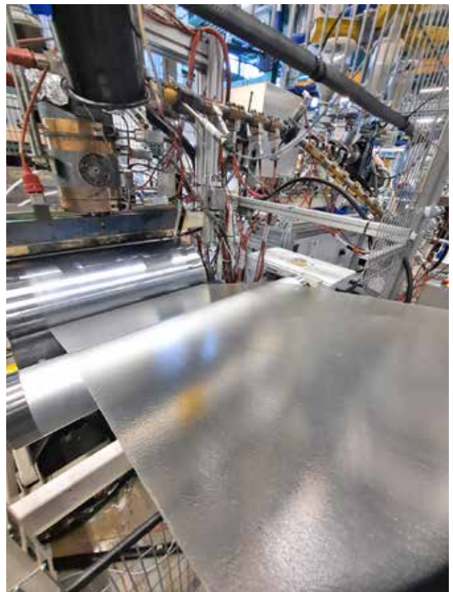
Kuva 2. Pilot-mittakaavan ekstruusioikalvon valmistusta ThermoCell -materiaalista.
