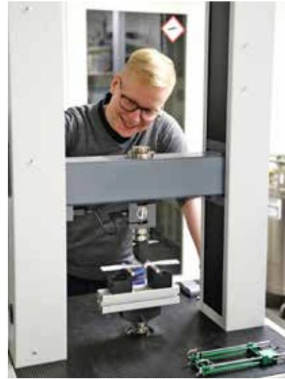
Taivutuslujuuden testausta koesauvasta ISO 178-standardin mukaisesti
