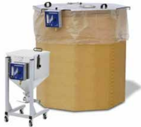
Materiaaliastian peittäminen: Pienten määrien kuivana pitoon soveltuu siirrettävä kannellinen, kuivalla ilmalla ylipaineistettu siilo, suuremmilla materiaalimäärillä esim. oktabiineissa voidaan käyttää erillistä kuivailmaohjauksen sisältävää kantta.
