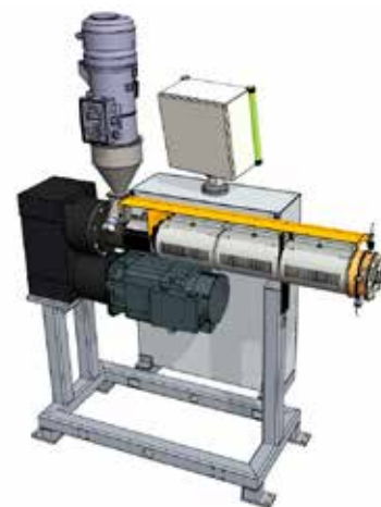
3D-malli Extronin suunnittelemasta Ex-50 -ekstruderista, joiden runkorakenteet suunnitellaan asiakastarpeen mukaan.
