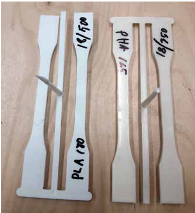
Kuva 1. Ruiskuvallettuja koesauvoja odottamassa testausta. Vertailun vuoksi kuvassa on myös PLA:sta valmistettuja koesauvoja. PHBV kopioi muotin pinnan tekstuuriin erittäin tarkasti pienilläkin jälkipaineilla ja tämä saattaa ilmetä taipumuksena tarttua muottiin tavannaista tiukemmin.
