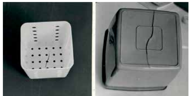
Halkeamat ilmenivät tämän näköisinä ruiskuvalutuissa PE-HD-tuotteissa.
