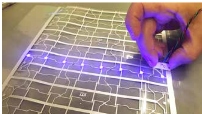
Kuva 1. Painettu hybridi-integroitu LED-kalvo, jossa kalvomateriaalina PLA.
