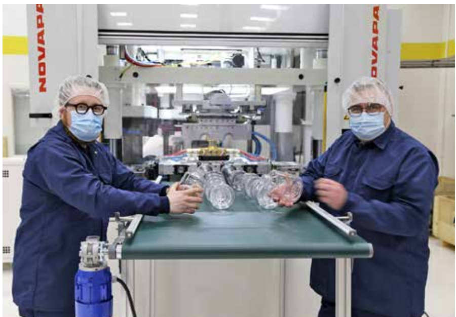
Tomi Villilä ja Matti Pilviö. Taustalla Helsingin tehtaan puhdistilan Novapax NSB 850 ruiskupuhallusmuovauskone.
