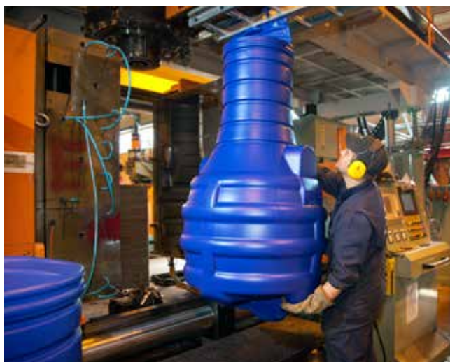
Puhallusmuovaus on nopea ja kustannustehokas sarjavalmistusmenetelmä isoillekin säiliöille. (Kuva: VMT Plastic Solutions)
