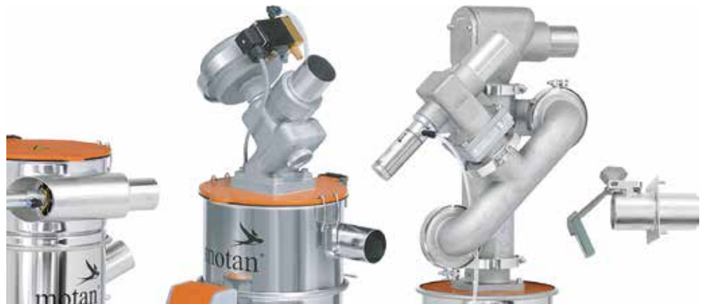
Vasemmalta oikealle: Raaka-aineimuri kylkeen asennetulla alipaineventtiilillä ja kulmaan käännettyllä sisääntulolla, imuri kalvoalipaineventtiilillä puhdistilakäyttöön, pölynerotusmoduuli sekä vahvistettu (karkaistu) raaka-aineen sisääntulon läppä
