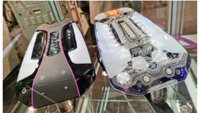
Arburgin osastolla yhteistyössä Tactotecin kanssa valmistettu auton paneeli. Paneelin piirilevy on painettu sähköä johtavalla musteella.
