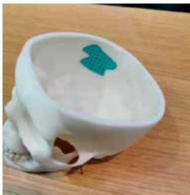
Arburgin valmistamalla Freeformer 3D-tulostimella valmistettu kalloimplantti PLLA-materiaalista.
