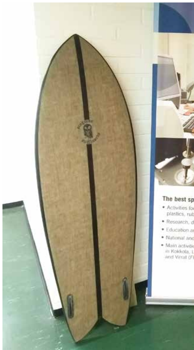
Esimerkki kerroslevyrakenteesta: Lainelauta jossa ydin kierrätettyä EPS-levyä ja pinta bioepoksi-pellavakangas komposiittia. Kuva Pauli Hakala
