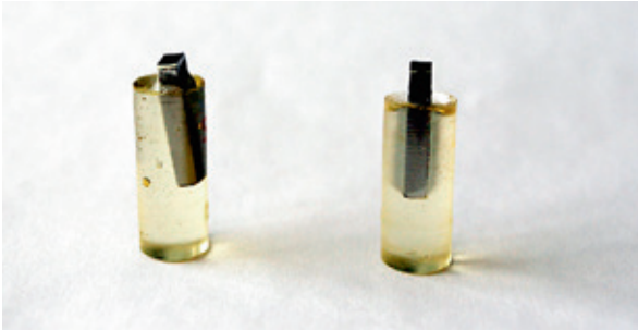
Kuva 1. Luistimen terän palat valettuna epoksiin testaamista varten.
