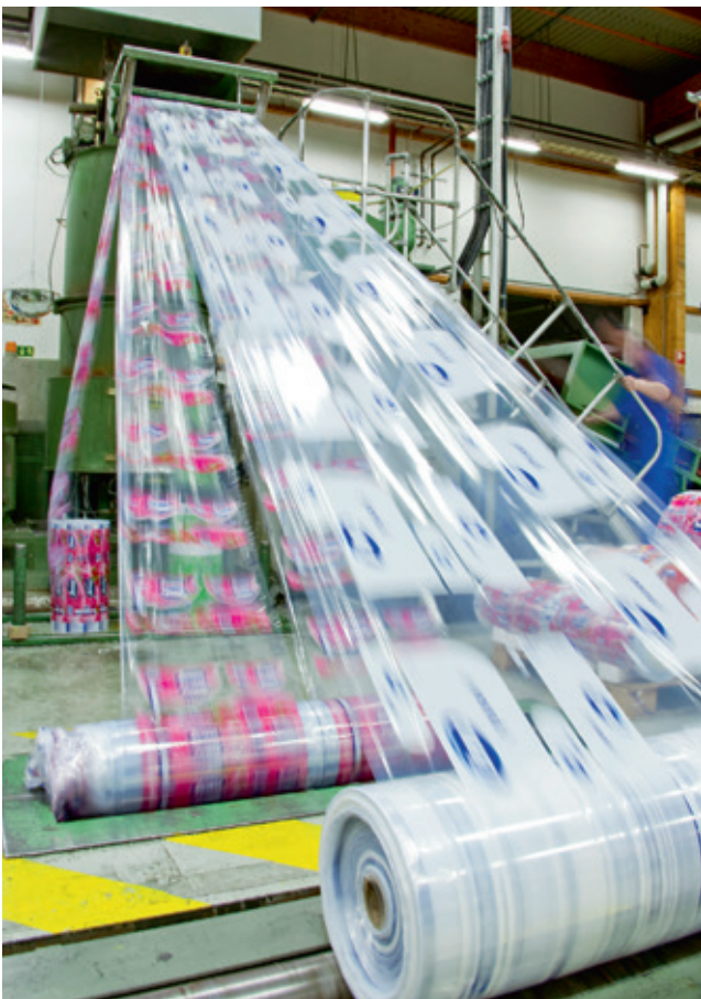
Uusiogranulointikoneeseen syötetään kierrätettävät kalvot ja kone granuloi jatkokäyttöön soveltuvaa uusiogranulaattia.
