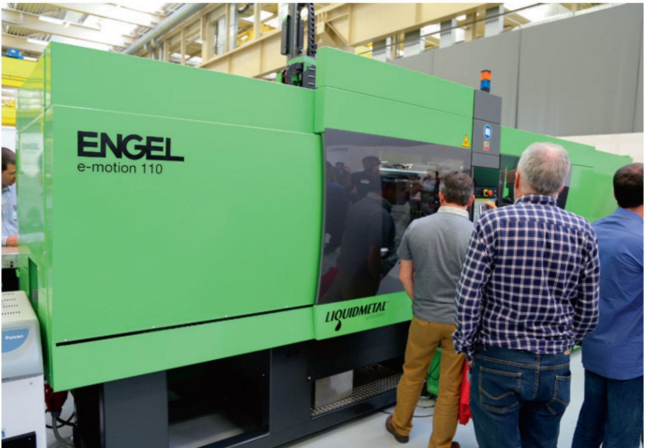
Ruiskuvalukoneen mahdollisuuksien rajat ovat moninaiset. Flexseal valmistaa raakakumista tiivisteitä ja e-motion 110 jalostaa Liquid Metalista ruiskuvalamalla metalliosia.
