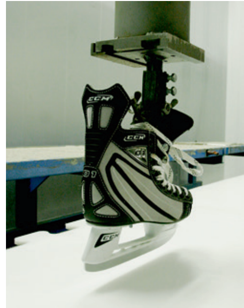
Kuva 4. Luistimen ja keinojään kitkan mittaaminen TTY:n kylmähuoneen robotin avulla.
