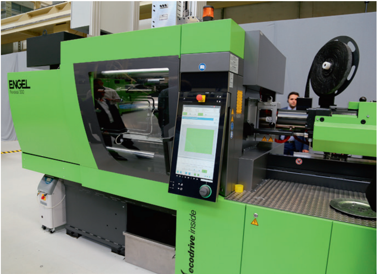
Ruiskuvalukoneen mahdollisuuksien rajat ovat moninaiset. Flexseal valmistaa raakakumista tiivisteitä ja e-motion 110 jalostaa Liquid Metalista ruiskuvalamalla metalliosia.
