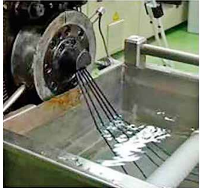
Kuvat 371 ja 372. Vasemmalla suutin valmistettaessa linssin muotoisia granulaatteja, jotka lentävät ilmassa sen jälkeen kun pyörivä terä on leikannut ne irti suuttimesta tulevasta muovivirrasta. Oikealla viisi lankaa, jotka tulevat ulos suuttimesta jäähdytyskylpyyn, jonka jälkeen ne leikataan granulaatiksi.
