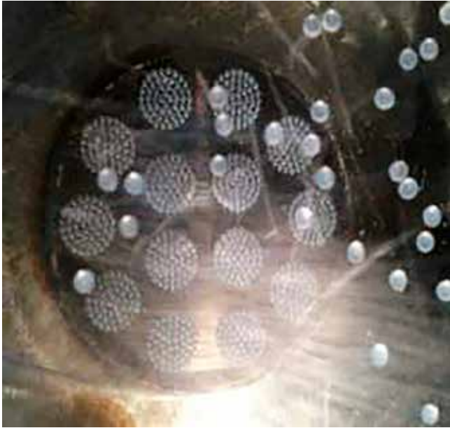
Kuvat 371 ja 372. Vasemmalla suutin valmistettaessa linssin muotoisia granulaatteja, jotka lentävät ilmassa sen jälkeen kun pyörivä terä on leikannut ne irti suuttimesta tulevasta muovivirrasta. Oikealla viisi lankaa, jotka tulevat ulos suuttimesta jäähdytyskylpyyn, jonka jälkeen ne leikataan granulaatiksi.
