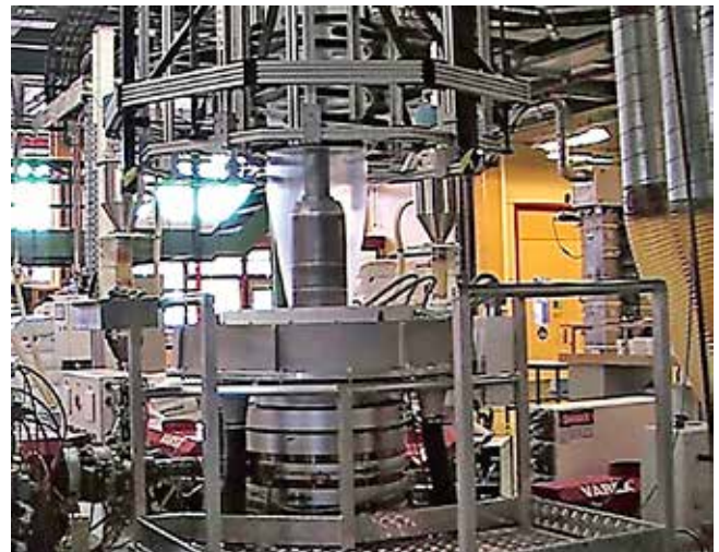
Kuva 365. 7-kerros kalvopuhallussuutin DuPontin teknisessä tutkimuskeskuksessa Genevessä. Ekstruuderit sijaitsevat kehässä halkaisijaltaan noin 75 senttisen puhallussuuttimen ympärillä. Puhallettava kalvo näkyy kuvassa suuttimen keskellä.
