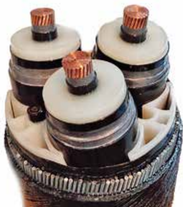
Kuva 367. Merikaapeli kolmella punotulla kuparijohtimella (halkaisija n. 30 mm), jotka on eristetty monella kerroksella. Kaapelin vakauttamiseksi on yksittäisten johtimien tueksi asennettu ekstrudoidut MDPE-profiilit. Nämä hitsataan yhteen peilihitsaamalla ennen kuin ne suljetaan vaipan sisään yhdessä johtimien kanssa. Aukkoja (nuoli) voidaan käyttää suojana optisia kaapeleita varten tai nesteitä kuljettavia putkia varten.
