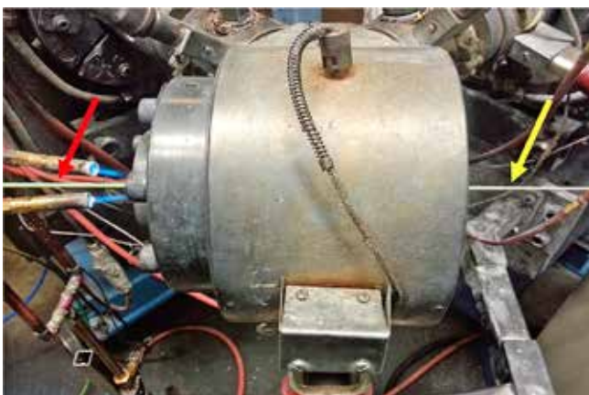
Kuva 366. Kaapeleita valmistetaan ekstruoidimalla kulmasuuttimella. Tässä kuvassa valmistetaan maadoituskaapelia, jossa kiiltävä yksinkertainen johdin tulee sisään oikealta (keltainen nuoli) ja päällystetään sekä vihreällä että keltaisella pehmeällä PVC:llä (koekonstruusio), jonka jälkeen se tulee ulos vasemmalta (punainen nuoli) ja sitten kaapeli jäähdytetään ja kelataan rullalle. Kaasuliekit (punaisen nuolen oikealla puolella) polttavat kaapelin päältä pois mahdollisia kerrostumia.
