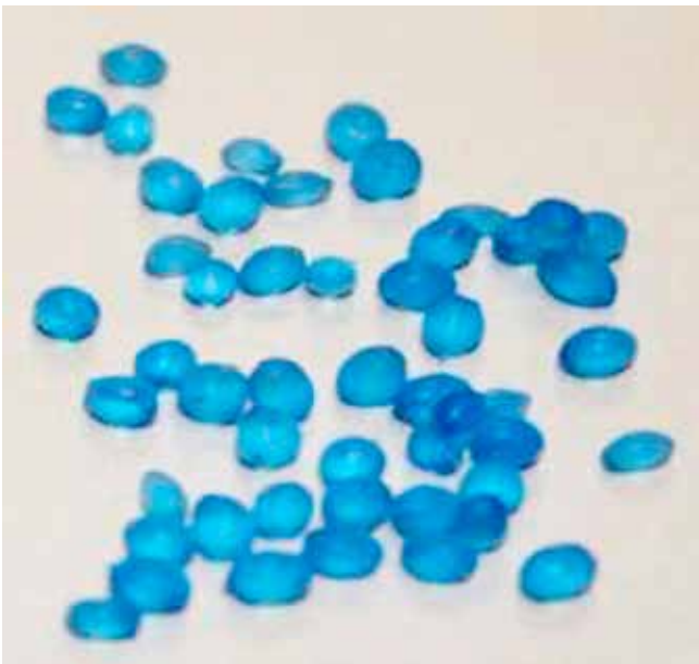
Kuvat 373 ja 374. Vasemmalla linssin muotoisia granulaatteja. Tämä granulointimenetelmä on usein käytössä raaka-aineilla, joilla on matala työstölämpötila, kuten PE ja PP. Oikealla sylinterimäisiä granulaatteja. Tämä on vallitseva granulointimenetelmä esim. lasikuitulujitetuilla raaka-aineilla.
