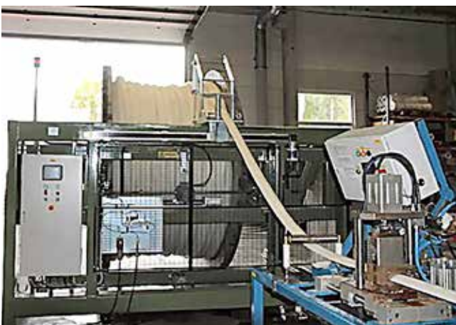
Kuva 354. Tässä tuotetta kelataan rumpulle. Edessä oleva laite on rei'ittäjä, joka iskee profiiliin reiän tasaisin välein.
