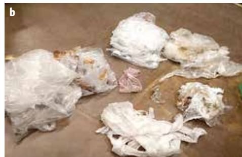
Materiaalistatuksen arvioinnin kohteina oli kaksi granulaattilaatua, joista toinen oli valmistettu puhtaasta ja läpinäkyvästä muovipakkauksesta (a) ja toinen runsaasti etikettejä ja teippiä sisältävästä muovipakkauksesta (b).
