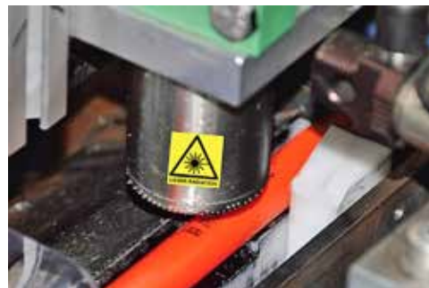
Kuva 350. Lasermerkkkaus antaa paljon kestävämmän merkkauksen, mutta vaatii huomattavasti kalliimman laitteiston.
