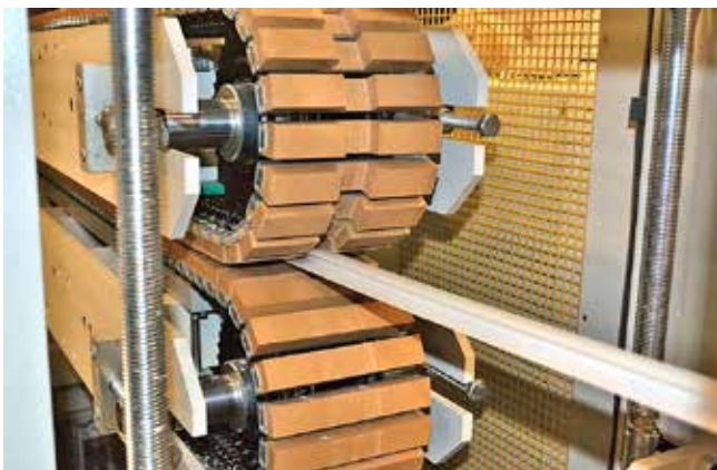
Kuva 348. Profiili menossa sisään vetolaitteeseen.
