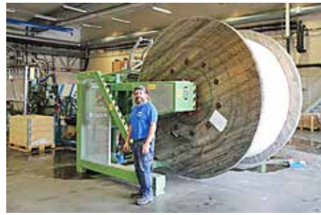
Kuva 355. Kuvassa kelauslaite, jossa rumpun halkaisija on 3 metriä, mikä on sopiva koko maantiekuljetuksiin.
