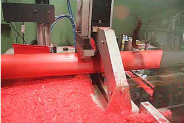
Kuva 352. Katkaisu sahalalla 90 asteen kulmassa
