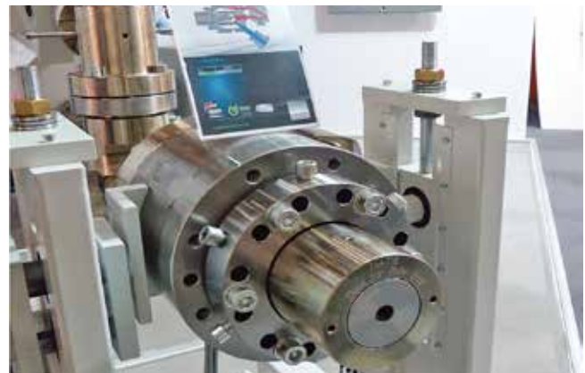
Kuva 362. Kuvan putkityökalulla valmistetaan kolme kerrosta kahdella ekstruuderilla. Työkalun rakenne on esitetty seuraavassa kuvassa. Koekstruuderit sijaitsee pääekstruuderin päällä ja sininen kerros syötetään taustalla pystyssä näkyvästä syöttöyksiköstä.
