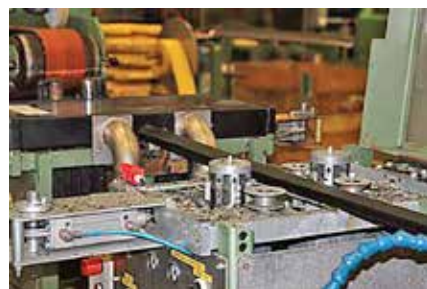
Kuva 351. Tarkkuusjyrsintää profiilille, jonka leveystoleranssi on tässä tapauksessa +/- 0,05 mm. Musta profiili kulkee läpi jyrsintäyksikön 1, joka on käynnissä ja peitetty suojakuvulla. Molemmat taivutetut putket ovat imuilmaputkia. Etualalla näkyy jyrsintäyksikkö 2, jota käytetään toiselle profiilille. Jyrsintäyksikön 2 suojakupu on auki, joten molemmat jyrsintäpäävät ovat näkyvissä.
