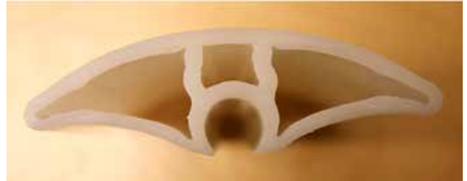
Kuva 356. Profiili, joka toimitetaan rumpulle kelattuna. Profiilia käytetään täytteenä suurissa merikaapeleissa ja sitä jatketaan hitsaamalla päät yhteen peilihitsauksella, niin että tuote on monta kilometriä pitkä.
