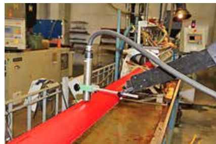
Kuva 349. Mustesuihku-kirjoituspää kaapeli-putken merkkauksessa.
