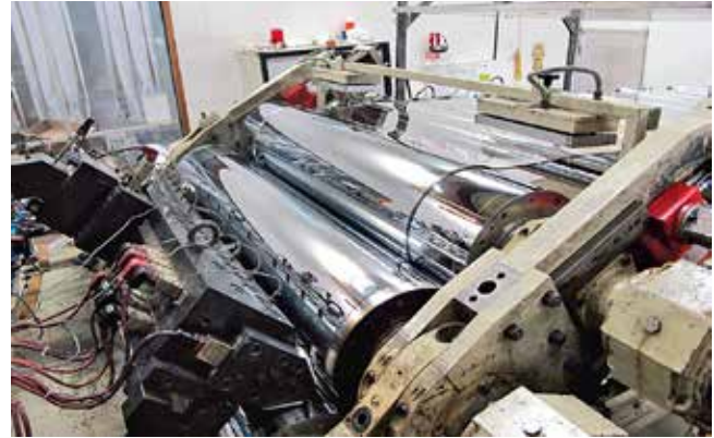
Kuva 360. Vasemmassa reunassa 2050 mm leveä suutintyökalu, monella lämpöanturilla varustettuna. On tärkeää, että lämpötila on tasainen koko leveydeltä ja erityisen tärkeää, kun koekstruoidaan levyjä monella kerroksella. Lähde: Arla Plast Ab
