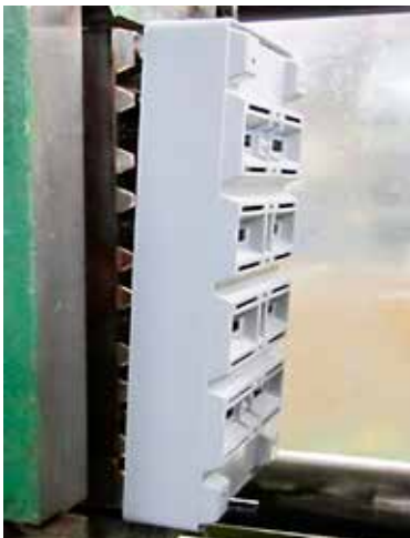
Kuva 612. Kappale on työnnetty irti pistimen päältä, mutta jää roikkumaan ulostyöntötappien päälle. Kuva: K.D. Feddersen
