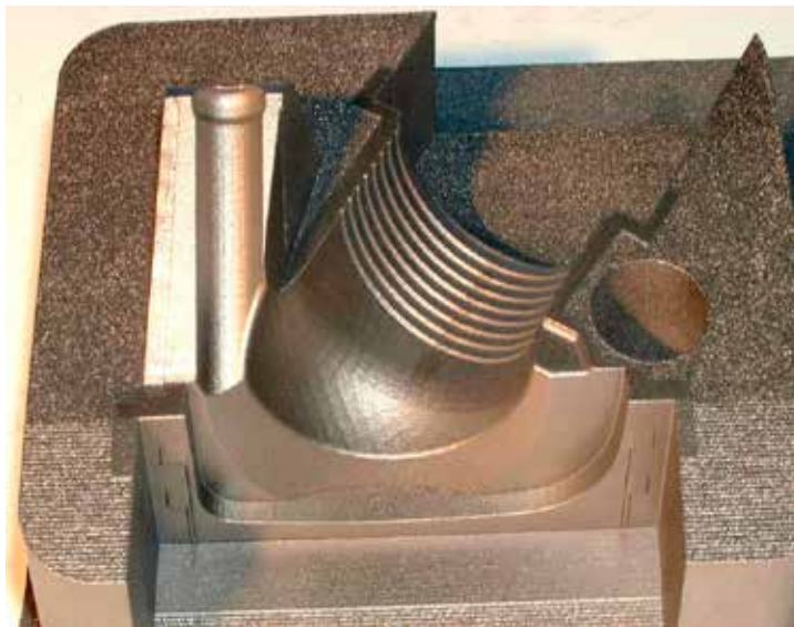
3D-tulostamalla teräksestä valmistettu muotin osa
