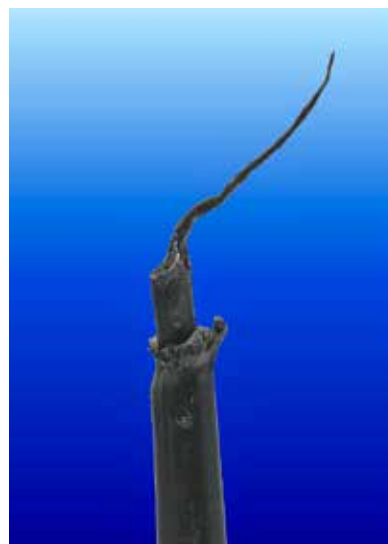
Kuva 614. Langan muodostuminen sekä osakiteisellä että amorfisella muovilla.
