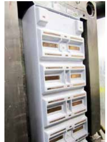
Kuva 611. Kappale on seurannut liikkuvan muottipuoliskon mukana, mutta ulostyöntäjä ei jaksanut työntää kappaletta irti muotista. Kuva: K.D. Feddersen
