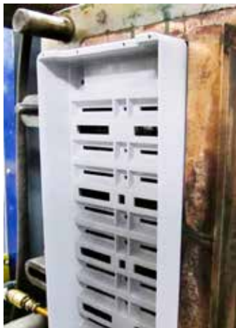
Kuva 610. Kappale ei seuraa liikkuvan muottipuoliskon mukana muotin avauksessa, vaan on tarttunut kiinteään muottipuoliskoon. Kuva: K.D. Feddersen
