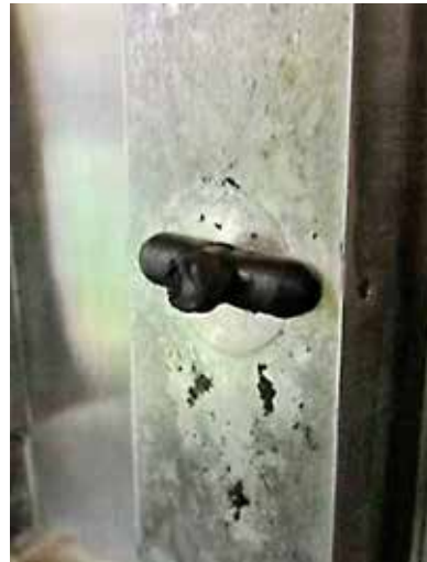
Kuva 613. Valutappi voi kiinni jäädessään kuumentaa messinkiruuvien ja sulattaa sen valutapin sisään. Kun ruuvi on jäähtynyt ja muovi kovettunut vedetään tappi varovasti ulos pihtien avulla. Kuva: K.D. Feddersen
