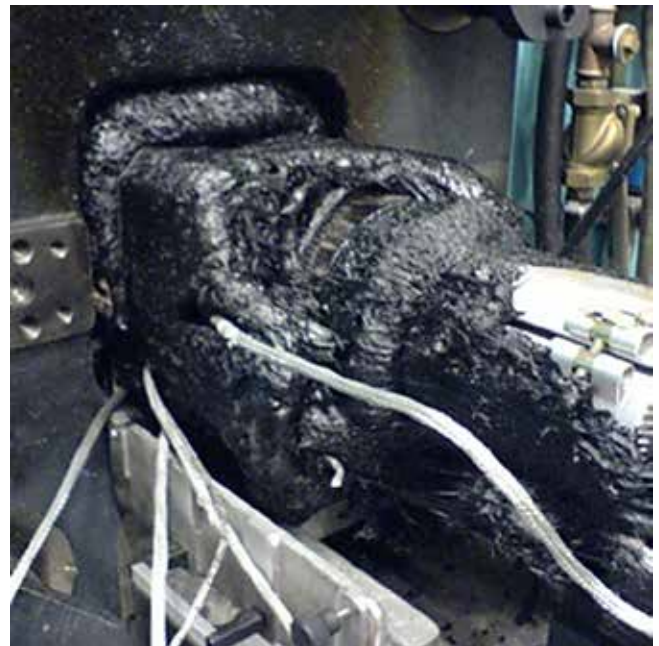
Kuva 565. Kuvassa suuttimen ja muotin välistä ruiskuvalukoneen sulatussyylinterin päälle vuotanutta raaka-ainetta. Koska suuttimen alue on turvallisuussyistä suojattu peltisuojuksella ei vuotoa havaittu ennen kuin se oli kehittynyt pienestä ongelmasta vähän suuremmaksi ongelmaksi, joka vaatii usemman tunnin puhdistustyön.
