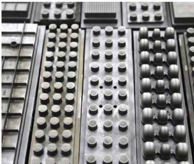
Grafiittista työstettyjä elektrodeja erilaisiin LED-linsien muotteihin
