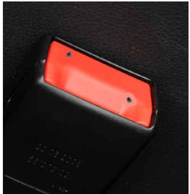
Kuva 562. Turvavyön punaisessa painonapissa näkyvät mustat pilkut ovat ei-toivottu poikkeama, jota normaalisti kutsutaan pintavirheeksi.
