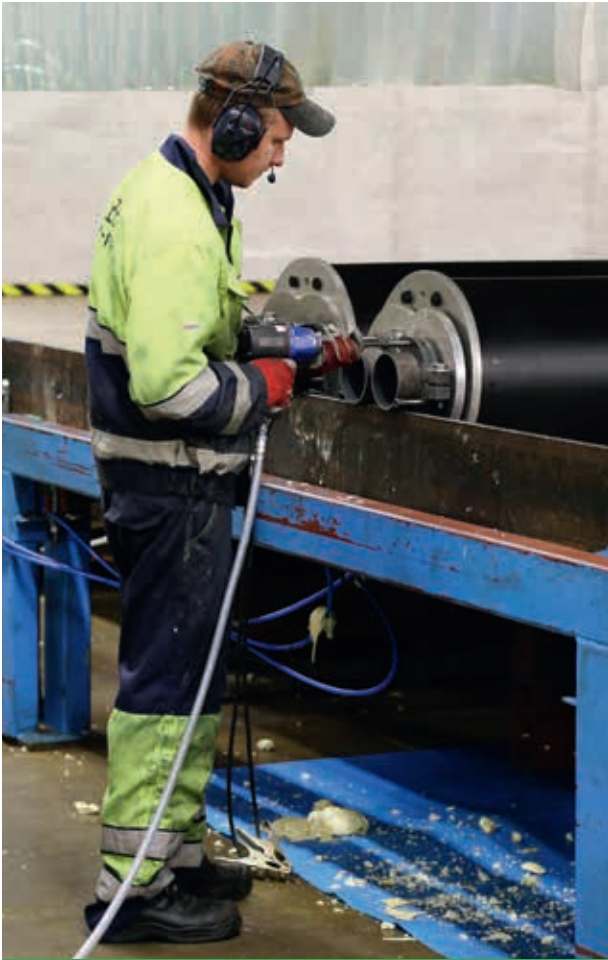
10 Erik Kinnunen kiristää paineputkien laippoja kiinni.
