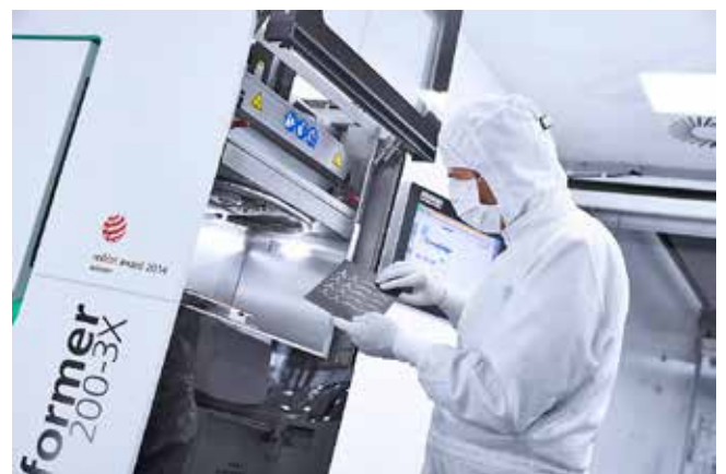
Abb. 4: Freeformer'illa voidaan myös työskentää FDA hyväksytyjä alkuperäisiä materiaaleja ja se soveltuu puhdistiloihin. Lääketieteellisissä sovelluksissa sitä voidaan käyttää absorboituvien implanttien valmistamiseen.
