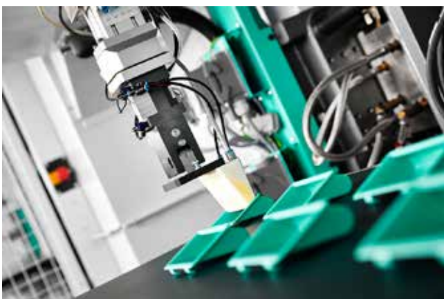
Abb. 4: Freeformer'illa voidaan myös työskentää FDA hyväksytyjä alkuperäisiä materiaaleja ja se soveltuu puhdistiloihin. Lääketieteellisissä sovelluksissa sitä voidaan käyttää absorboituvien implanttien valmistamiseen.
