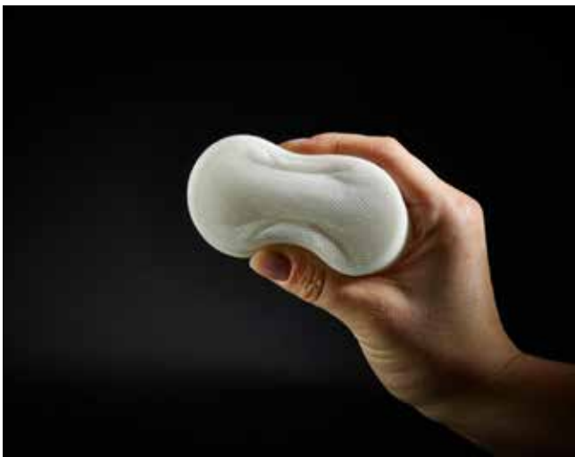
Kuva 2: Komponenttien tiheyden voidaan vaikuttaa kohdennetusti APF-prosessissa, esimerkkinä hunajakennorakenteet, jotka on valmistettu pehmeästä TPE Medalist MD 12130H:sta (kovuus 32 Shore A).
