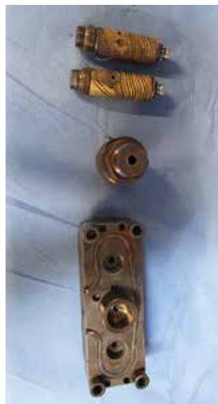
Ruiskuvalusuutin pyrolyysin ja UÅ:n jälkeen
