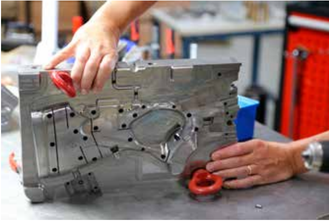
Uudet muotit käyttöönotto tarkastetaan aina ennen asiakkaalle toimitusta. Muottiinsertin tarkastus menossa.
