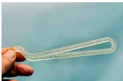
Kuva 601. Kuvassa kaviokoukku valmistettu polykarbonaatista. Sen sisällä puutteellisesta kuivauksesta johtuvia höyrykuplia.
