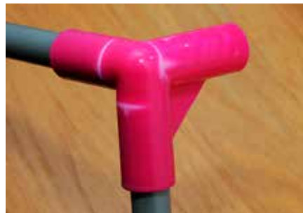
Kuva 605. Kuvassa putkiliitin, johon on ilmaantunut valkomurtumajälkiä putkien paikalleenasennuksen jälkeen.
