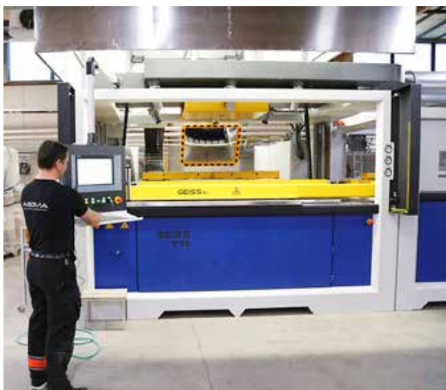
GEISS T10 -muovaukseen kaikki liikkeet on toteutettu tarkalla servo-ohjauksella
