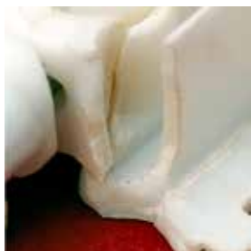
Kuva 604. Kuvassa asetaalimuovista valmistettu kappale, joka on hajonnut normaalissa kuormitusolotilanteessa, koska se on ollut kosketuksissa vahvaan happoon.
