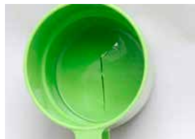
Kuva 602. Kuvassa SAN-muovista valmistettu muki, joka haljennut ulostyönön aikana.
