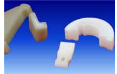
Kuva 581. Sahattaessa kappale halki löytyy kappaleen sisältä onkaloita, kuten oikeanpuoleisessa asetaalikappaleessa tai mikrohuokosia, kuten vasemmanpuoleisessa lasikuitulujitetussa polyamidikappaleessa.
