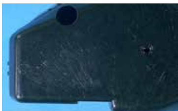
Kuva 584. Syöttöpisteestä lähtevä hopeinen raidoitus on merkki raaka-aineen leikkautumisesta.
