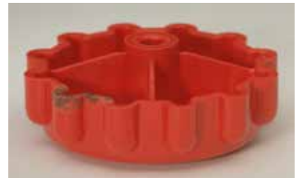
Kuva 585. Nk. "Diesel-ilmio", joka ilmenee, kun muotissa oleva ilma on puristunut kasaan ja kuumentunut. Kuva: DuPont
